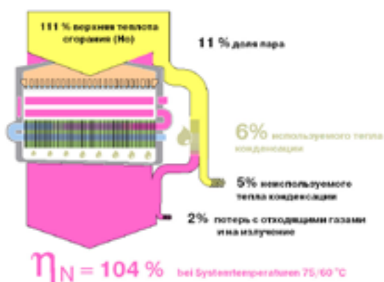
Рис.5: КПД современного конденсационного котла при работе в системе отопления 75/60 °C.
